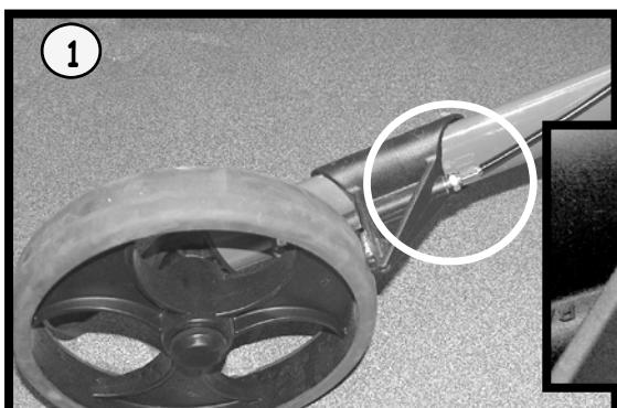
1. Løsne låsemutter og skru bremsejustering helt inn.
