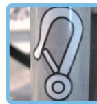
Muss der Rollstuhl mit z.B. einem Galgenkran zur Überwindung von Hindernissen angehoben werden, so dürfen die Anhängepunkte nur die 4, durch einen Hakenaufkleber (siehe Bild links) bezeichneten Punkte am Rollstuhlrahmen sein.
