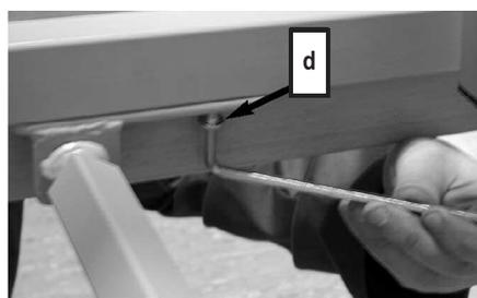
☞ Schrauben Sie die Halteböcke mit den dazugehörigen Schrauben [d] am Liegeflächenrahmen fest.
