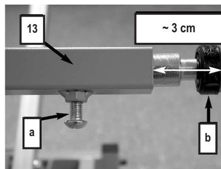
☞ Lösen Sie beide Schrauben [a] die zur Arretierung der Führungsrollen [b] dienen.
