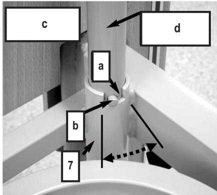
In den beiden Ecken des Liegeflächenrahmens, an der Kopfseite **[c]**, befinden sich zwei runde Aufrichterhülsen **[7]**. Die Aufrichterhülse hat an der Oberseite eine Aussparung **[a]**, die zusammen mit dem Stift **[b]** den Schwenkbereich des Aufrichters begrenzt. Der Aufrichter sollte auf der Seite des Bettes angebracht werden, wo der Patient ein- und aussteigt.
