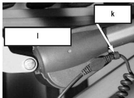
☞ Stecken Sie den Stecker mit dem durchgehenden Kabel in den Antriebsmotor für die Rückenlehne **[l]** ein.
