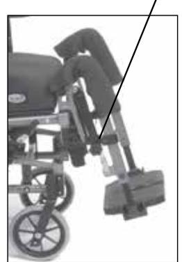
**!** Quetschgefahr. Greifen Sie bei der Einstellung des Beinstützenwinkels nicht in den Einstellmechanismus zwischen den beweglichen Teilen
