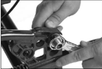
Achten Sie darauf, dass die Mutter an der Innenseite des Rahmens die Radbuchse komplett umschließt.
