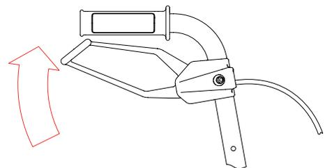
Um die Bremsen zu blockieren, drücken Sie die Bremshebel nach unten. Sie rasten dann selbsttätig ein. Zum Lösen ziehen Sie Bremshebel wieder nach oben.
