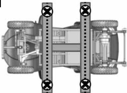
6. Platzieren Sie den vorderen Gurt entlang der vorderen Strebe des „H“-Rahmens und achten Sie darauf, dass beide Seiten gleich lang sind.
