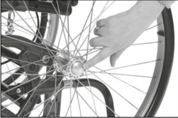
**⚠** Den Entriegelungsknopf loslassen und am Antriebsrad ziehen, um zu überprüfen, dass das Rad korrekt montiert ist.
