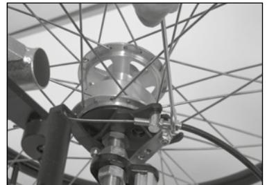
**Wenn die Bremse nicht richtig funktioniert:** Stellschraube auf der betreffenden Seite oder beidseitig zwei bis vier Mal im Uhrzeigersinn drehen, um den Bowdenzug einzustellen. Anschließend die Bremsen erneut überprüfen.
