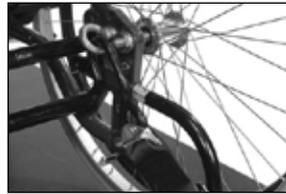
Der Winkel der Spanngurte sollte möglichst genau 45° betragen.
