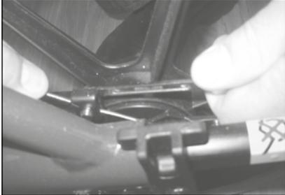
**Wenn der Bowdenzug zu locker ist:** Stellschraube bis zum Anschlag hineindrehen. Zum Straffen des Bowdenzugs die Zugklemme lösen und den Bowdenzug etwas weiter durchziehen. Zugklemme wieder festziehen und anschließend die Stellschraube erneut justieren.
