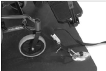
Vorne: Haken oder Spanngurthalterung verwenden.
