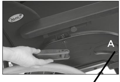
**⚠️** Beim Fixieren der Verriegelung der Armstütze (A) ist darauf zu achten, dass diese geringfügig herausragt.
