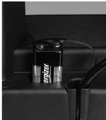
9-V-Blockbatterie für die Notabsenkung
